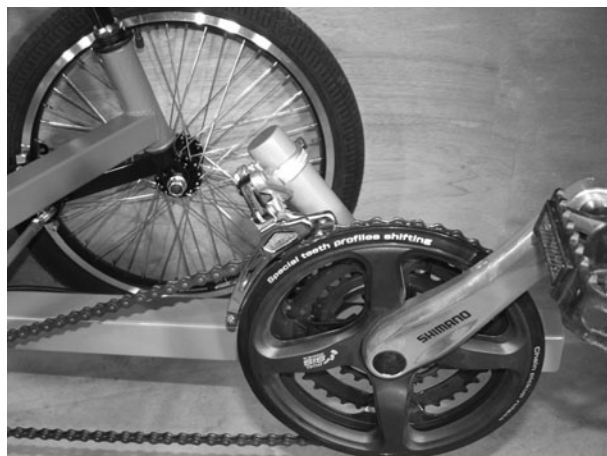
Figure 5-126 Setting up the derailleurs
