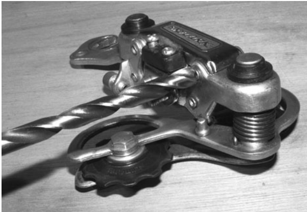
Figure 9-59 Removing the derailleur body
