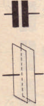
Joon. 75. Lihtsaimu kondensaatori skemaatiline ehitus ja tunnismärk.
