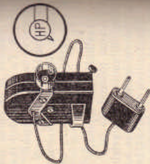
Joon. 219. Elektromagnetilise helipea väliskuju ja skemaatiline tähistus.
