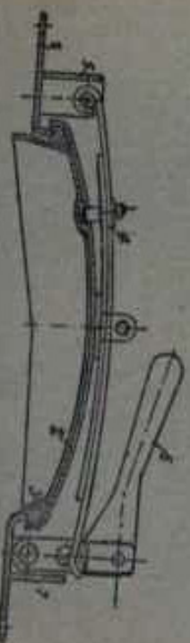
Joonis 12. Gasogeeni GAZ-42 täiteluugi kaane ja selle kinnitusseadise ehitus. 1 — täiteluugi äärik, 2 — luugi kaas, 3 — tihendusnoor, 4 — ääriket, 5 — lehtvedru kinnituse, 6 — kinnituspide, 7 — lehtvedru kinnituspide kinnituse.
