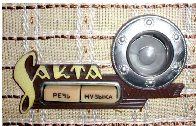
Рис. 4. Радиоло "Сакта", вид на переключатель тонрегистра и индикатор настройки
