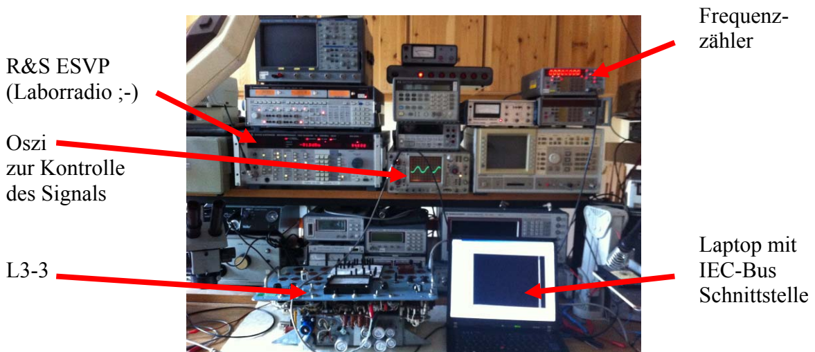
Abbildung 36: Messaufbau Langzeitmessung Oszillatorstabilität
