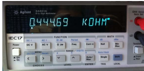
Abbildung 99: R57 gemessen mit 4Draht-Messung
