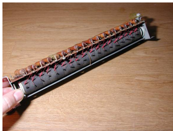
Abbildung 31: kleine Exkursion: vergleichbarer Schaden an der Linebox einer B-3 Hammondorgel
