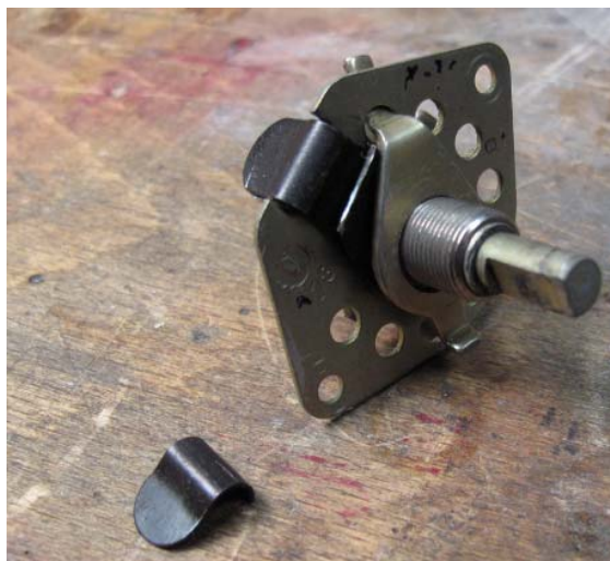
Abbildung 18: Drehschalter mit "halbiertem" Federblech
