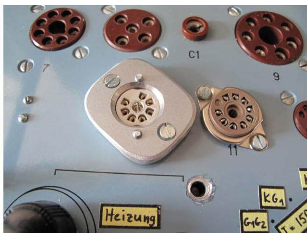
Abbildung 145: Pico7-Fassung fertig ausgewechselt
