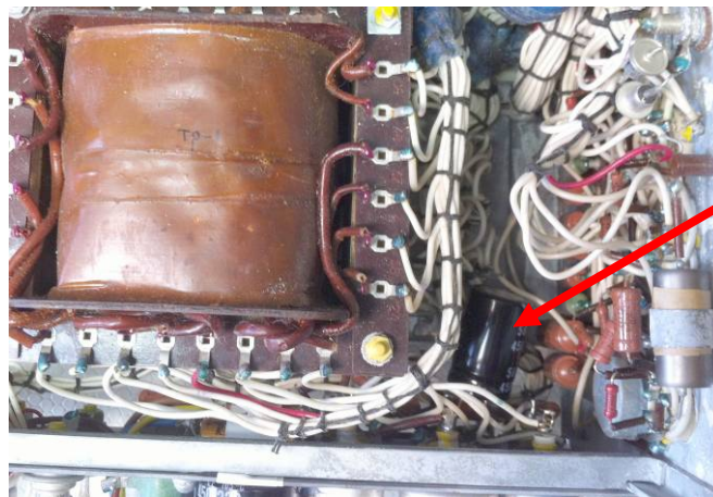
Abbildung 123: weitere 56\mu\text{F} für Gitter1
