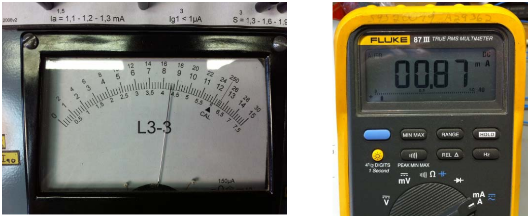
Abbildung 76: links: Anzeige Anodenstrom im L3; rechts: Anzeige im externen Strommesser
