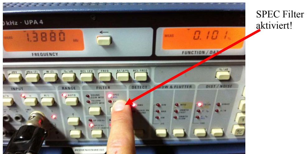
Abbildung 101: selektives NF-Voltmeter mit UPA4 Spezialfilter Nr. 19
