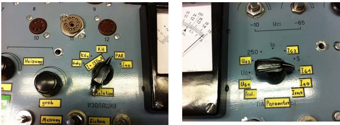
Abbildung 135: Einstellung im L3 für \mu A-Meter Betriebsart "Gitterstrom"
