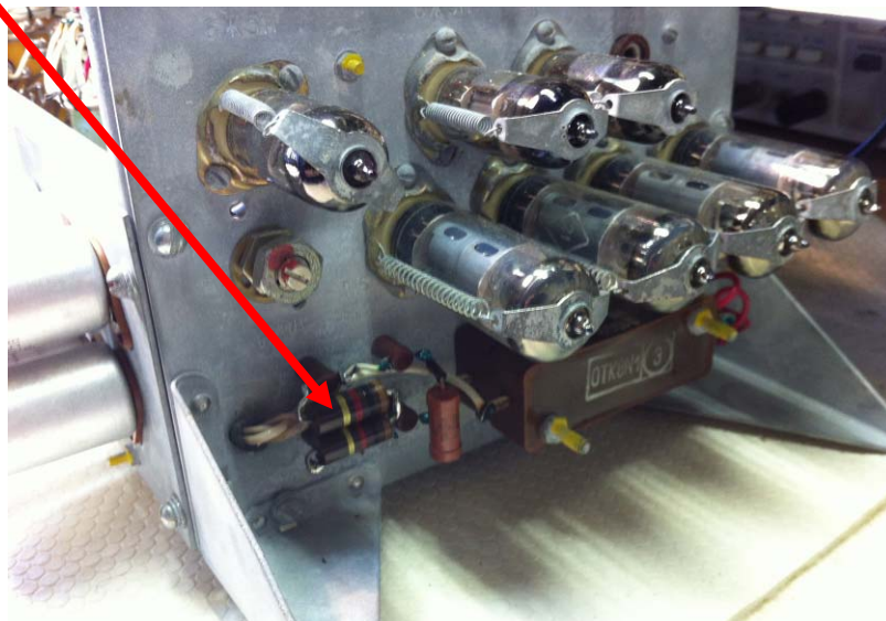
Abbildung 125: R110 wurde repariert
