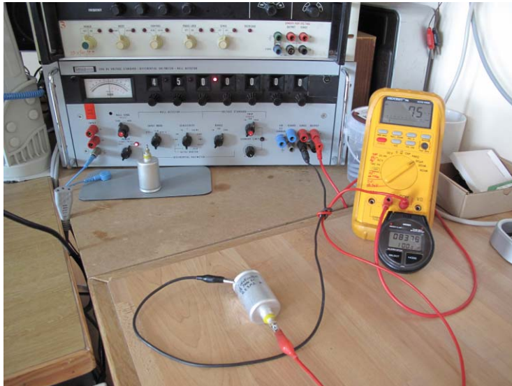
Abbildung 25: Hochspannungstest von C35 am Kalibrator
