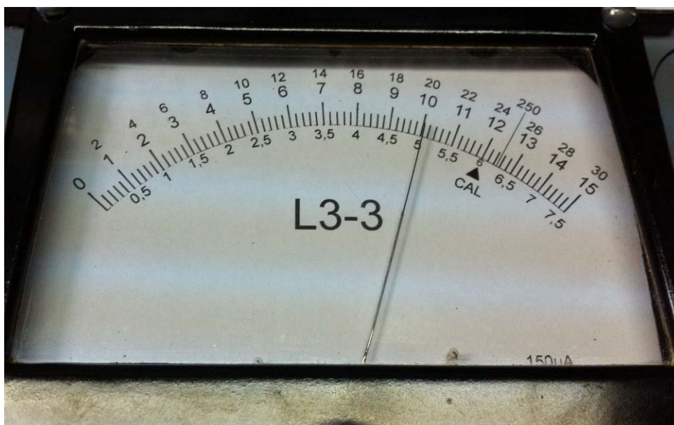
Abbildung 130: Isolationsmessung mit 100\mu\text{A} Teststrom
