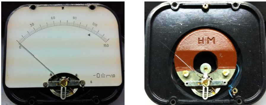
Abbildung 7: Messinstrument des L3-3 mit und ohne Skala
